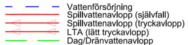
Figur 5. Utseendet på linjetyper för VA-ledningar på planritningar.
